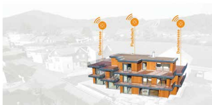
Orkanet von der Siworks AG analysiert, visualisiert und informiert, wenn sich in den Dachschichten Feuchtigkeit bildet und sich Wasser sammelt.
